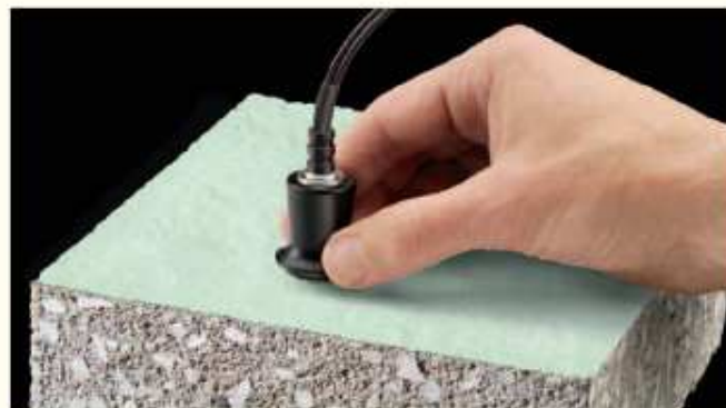
Pomiar grubych powłok ochronnych na posadzkach betonowych, rurach, konstrukcjach zabezpieczających i innych
