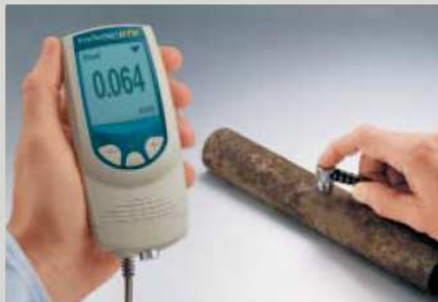
UTG Std mierzy pozostałą grubość ścianki stalowej, żeliwnej i innych wżartych przez korozję lub erozję
