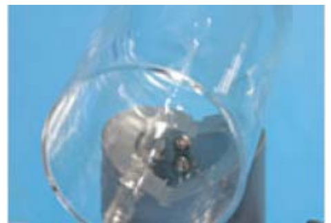
Kulki pomiarowe mają specjalną powłokę oraz precyzyjne wymiary w celu zapewnienia maksymalnej powtarzalności pomiarów
