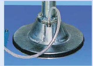
Standardowa płyta nadążana do małych kontenerów o średnicy wew. do 355 mm.
